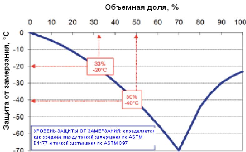
В любом случае, количество концентрата Coolstream HDC в охлаждающей жидкости должно составлять не менее 33% об. (чтобы обеспечить нормальную защиту от коррозии) и не более 70% об.
